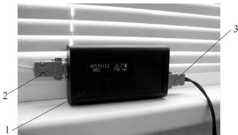
Рис. 4. Общий вид базового блока системы сбора данных: 1 – корпус; 2 – соединение с датчиком температуры; 3 – питание
